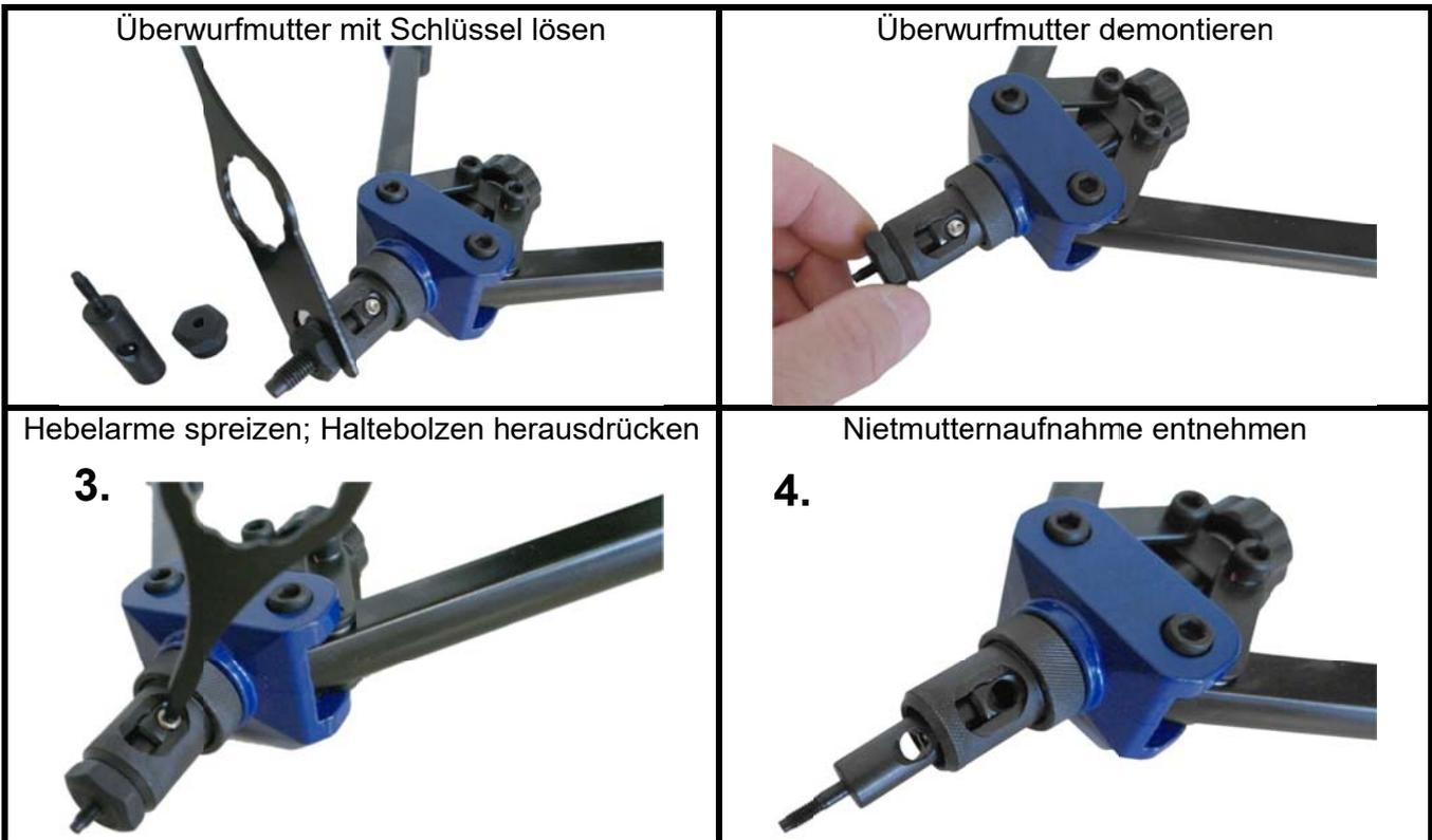
**5.** Erforderlichen Nietmutteraufnahme und Überwurfmutter in umgekehrter Reihenfolge montieren.
